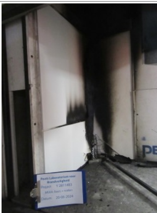
Proefstuk na afloop van de test
